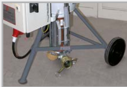
Manicotti di pressione con manometro collegati ai tubi per la malta
