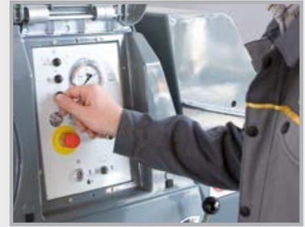
Die gut ablesbaren analogen Instrumente und robusten Schalter werden mit einer stabilen Klappe vor Schmutz und Beschädigungen geschützt.
