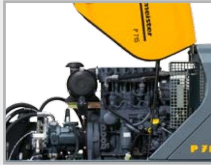
Zwei Antriebsvarianten: Mit zuverlässigem ölgekühltem 3-Zylinder Deutz-Dieselmotor (entspricht Abgasvorschrift Stage 3A) oder mit geräuscharm, umweltfreundlichem Elektromotor (30 kW)
